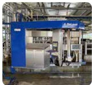
を与えられるとともに、乳房を自動で探し当て、洗浄して、搾乳機を装着し、自動調整後本格的に搾り始めます。終わると、ゲートが開いて、次のゾーンに誘導されます。ここでは、糞尿を自動で集める機械仕掛けがあり、作業を大幅に軽減しています。
