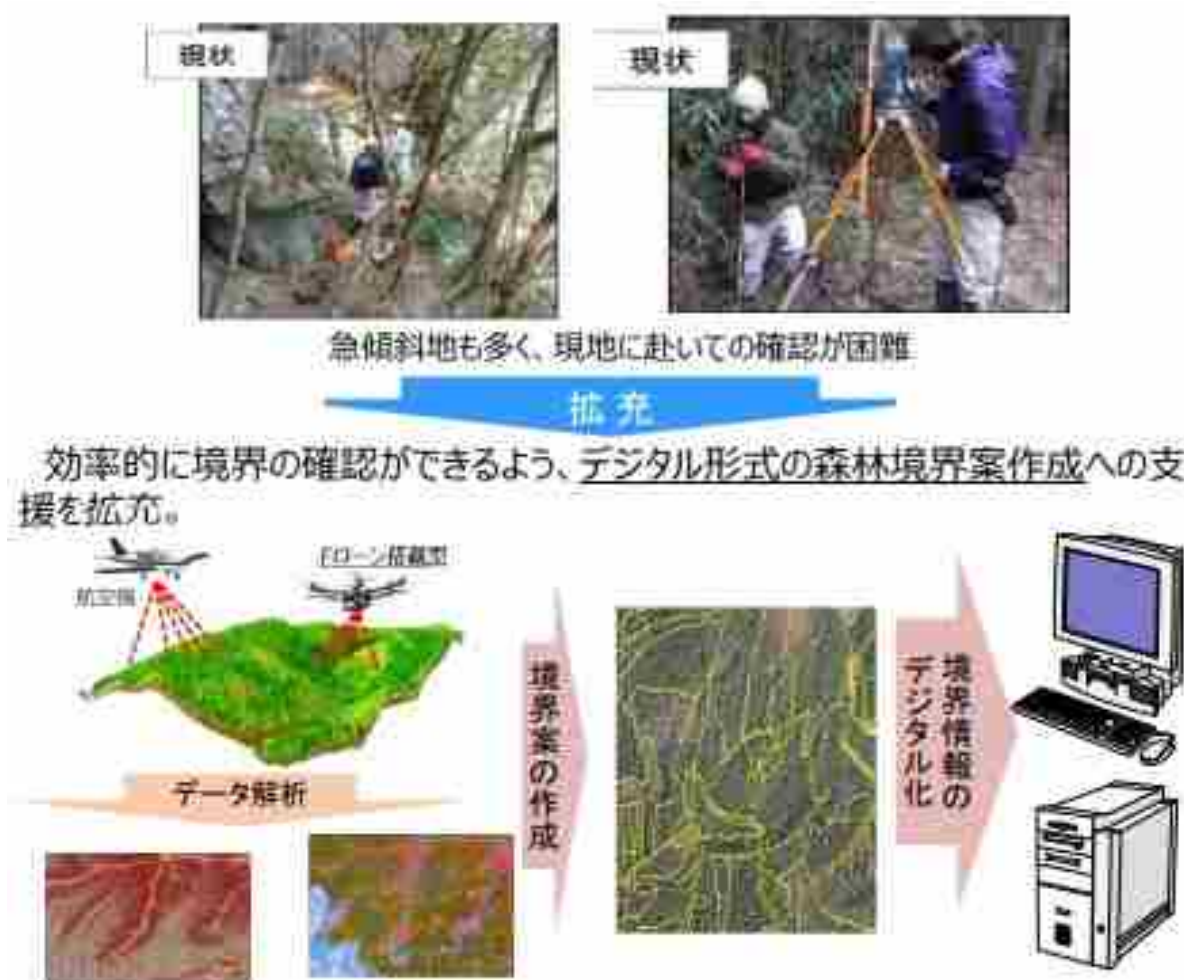
図 5-6 リモートセンシング法による森林境界明確化の概説
