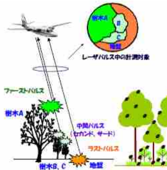
図 1-1 航空レーザ測量の仕組み
